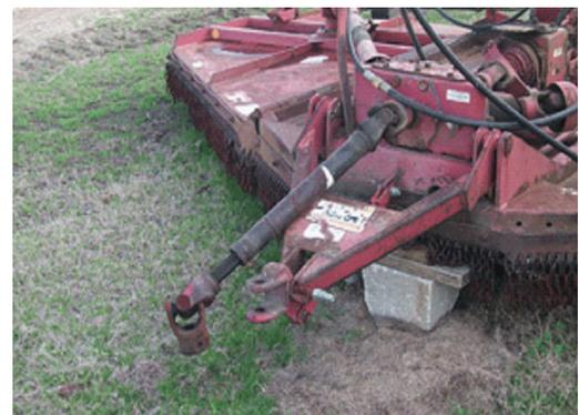
Eje del PTO sin cubiertas de seguridad.
