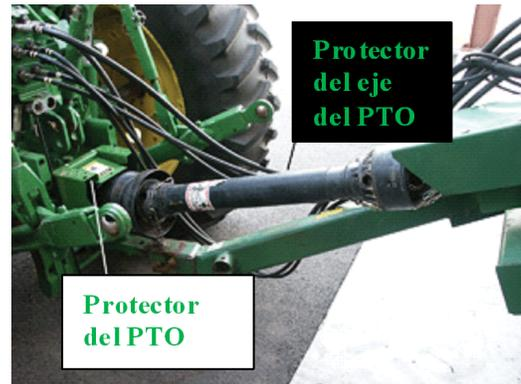
Protector del eje del PTO. Todas las partes que rotan son cubiertas y la cubierta no debe de rotar.
