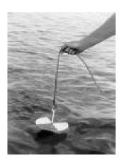
Figure 4.7. A Secchi Disk.
